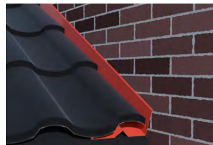
Detaliu de fixare a racordului calcan
